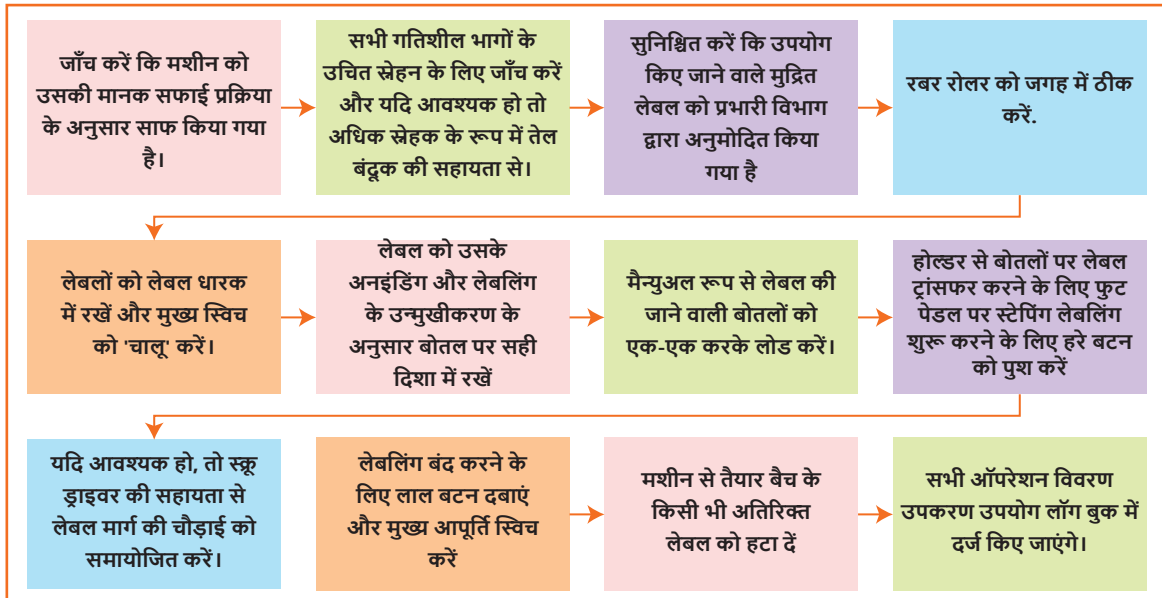
चित्र 7.2.1 लेबलिंग मशीन में लेबल लोड करने की मानक प्रक्रिया।
